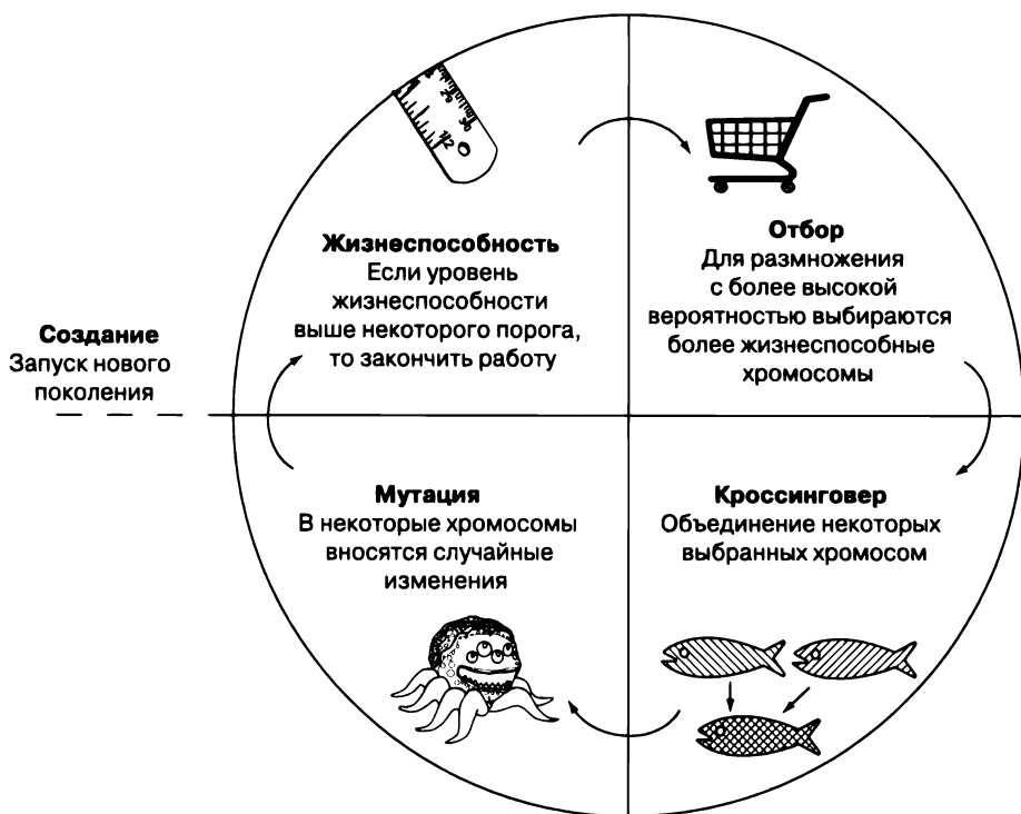
Рис. 5.1. Обобщенная схема генетического алгоритма
